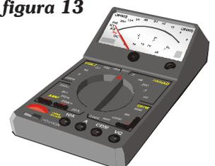
Este multímetro também trabalha a partir de indicação feita por ponteiro,
