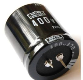
terminais, tendo polaridade definida. Quando essa tensão é aplicada, haverá internamente uma reação química onde será formada uma fina camada de óxido depositada na folha de alumínio, sendo que essa camada irá constituir o dielétrico. Como essa camada é bem fina, na realidade mais fina que o mais fino dielétrico utilizado nos capacitores convencionais, os capacitores eletrolíticos apresentam grande capacitância em pequeno volume.
