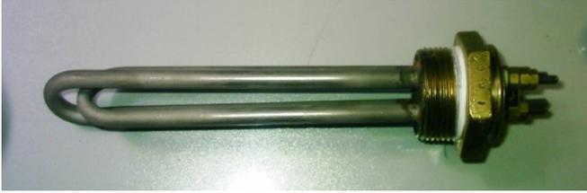
Resistência utilizada para aquecimento de água em grandes tanques
