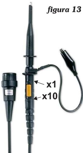
A resposta será utilizar uma ponta de prova que possua resistores de alto valor para atenuar o sinal que vai ao osciloscópio. Assim, na figura 13, podemos ver que isso é feito por uma pequena chave, que quando colocada para frente da ponta, fica na posição by-pass (ou direto), sem que haja atenuação. Mas, deslocando-a para trás, o sinal passa a ser atenuado pela ponta 10 vezes, e com isso o osciloscópio que antes poderia mostrar na tela
