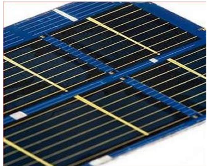
A eficiência da célula superior de GaAs é de 23,4%, muito próxima às células estado da arte feitas com esse material, mas que não possuem a vantagem da transparência e nem a baixa espessura. A eficiência da célula de germânio é de 3,5%, o que é superior ao aproveitamento da luz infravermelha em outras células solares do mesmo material.
